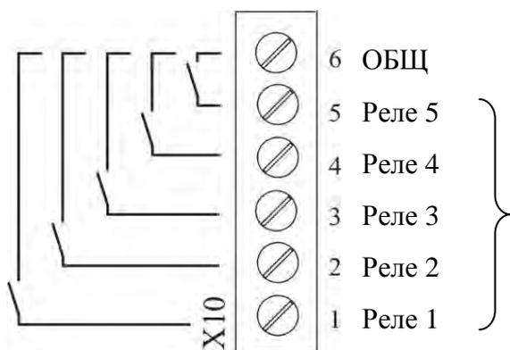
Контакты для переключения насосов с фиксированной скоростью. Учтите, что насосы с фиксированной скоростью нельзя переключить непосредственно с помощью платы реле (необходима внешний шкаф управления с пускозащитной аппаратурой для запуска насосов DOL или ТРЕУГОЛЬНИК/ЗВЕЗДА).
