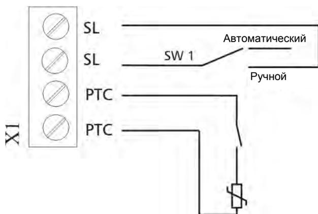
Внешний выключатель для включения **ТОЛЬКО ХОД**
