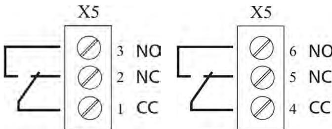
Когда используются контакты реле для включения внешнего реле, необходим соответствующий ограничитель сверхнапряжения типа RC или варистор для предотвращения помех во время переключения реле!
