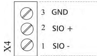
**Внутренний интерфейс RS-485** соединяет до 8 устройств HYDROVAR в системе с несколькими насосами. Для подключения каждого устройства HYDROVAR через интерфейс RS-485 можно использовать клеммы X4/4-6 на плате управления и даже клеммы X2/1-3 на блоке питания. (**Пример соединения:** работа с одним преобразователем-МАСТЕРОМ и тремя БАЗОВЫМИ преобразователями.)
