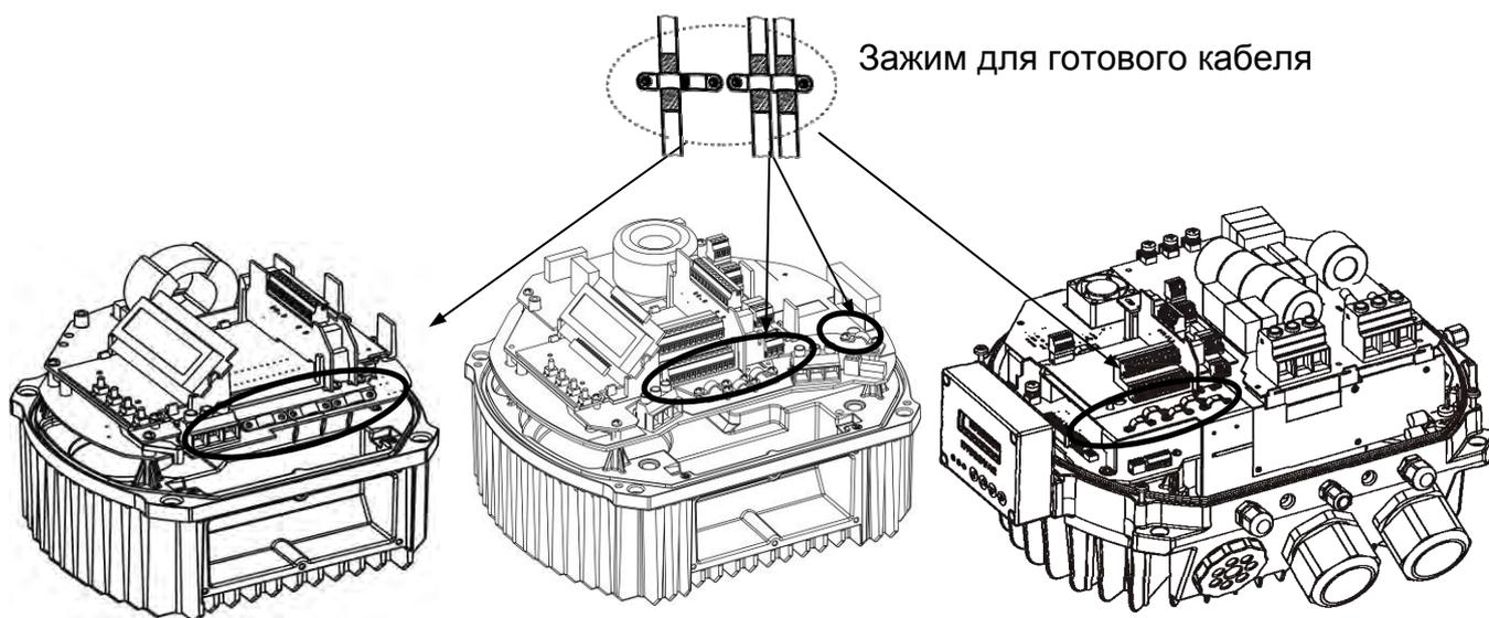
Для подключения экрана к заземлению с самым низким импедансом снимите изоляцию с сигнального кабеля и прочно подсоедините экран к заземлению.
