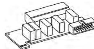
Плата реле подключается к разъему X6 на плате управления (см. главу 9.4.4.1).
