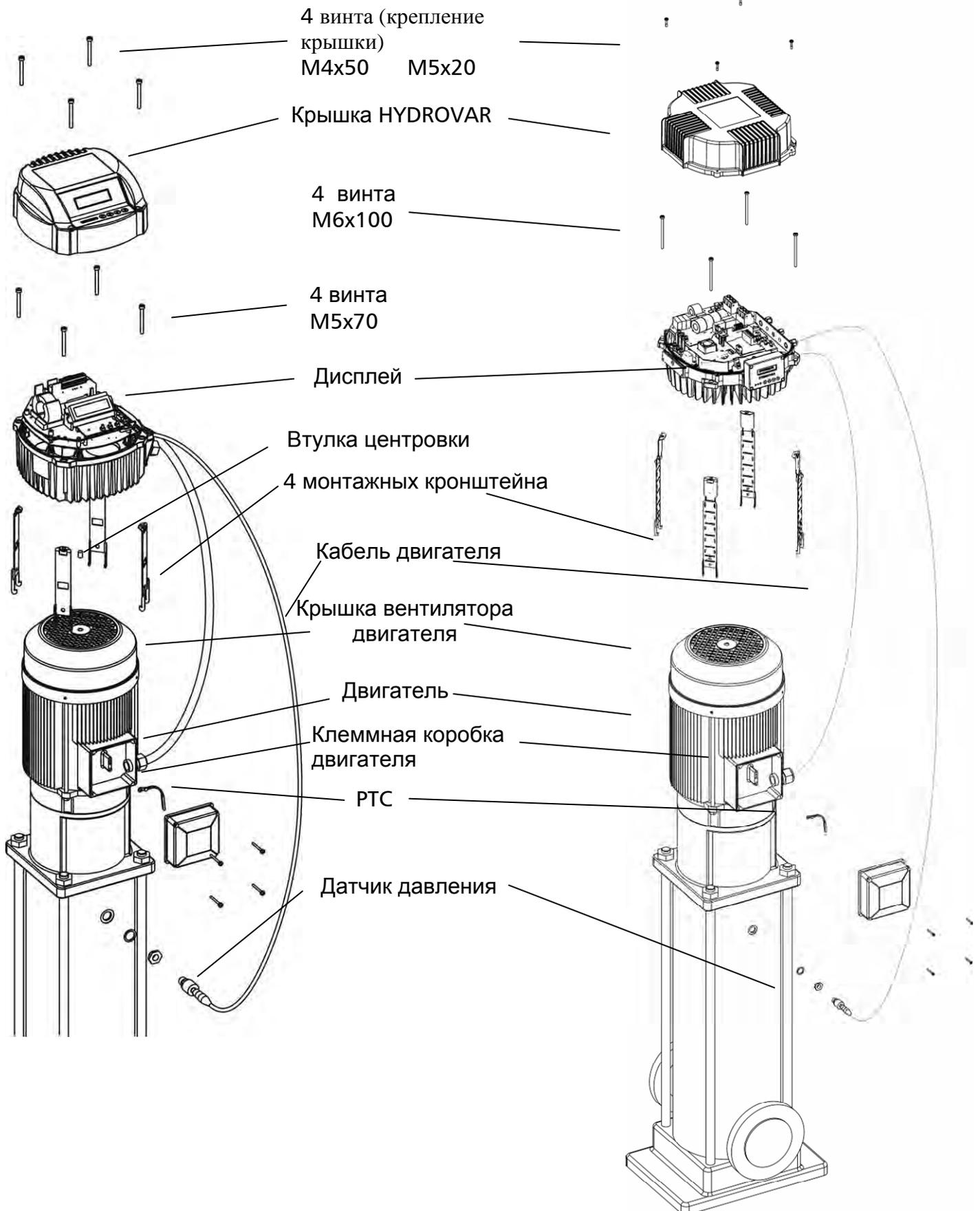
Чтобы снять с HYDROVAR крышку, нужно открутить 4 крепежных винта.
