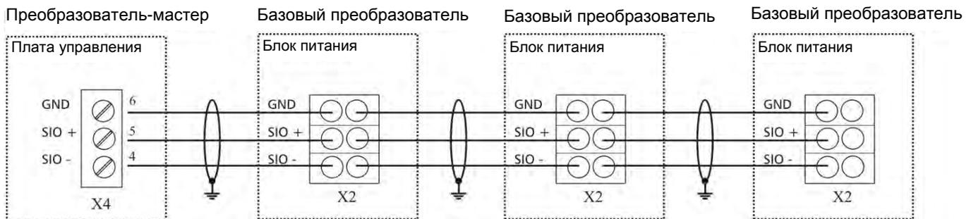
**Пользовательский интерфейс RS-485** на плате управления позволяет одному или нескольким устройствам HYDROVAR соединиться через стандартный протокол Modbus с внешним устройством управления (например, ПК). Этот интерфейс можно использовать для установки параметров и контроля HYDROVAR через внешние устройства. **Он также используется в конфигурации ОТДЕЛЬНОГО преобразователя HYDROVAR.**
