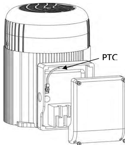
1. Снимите крышку клеммной коробки и извлеките клеммник
