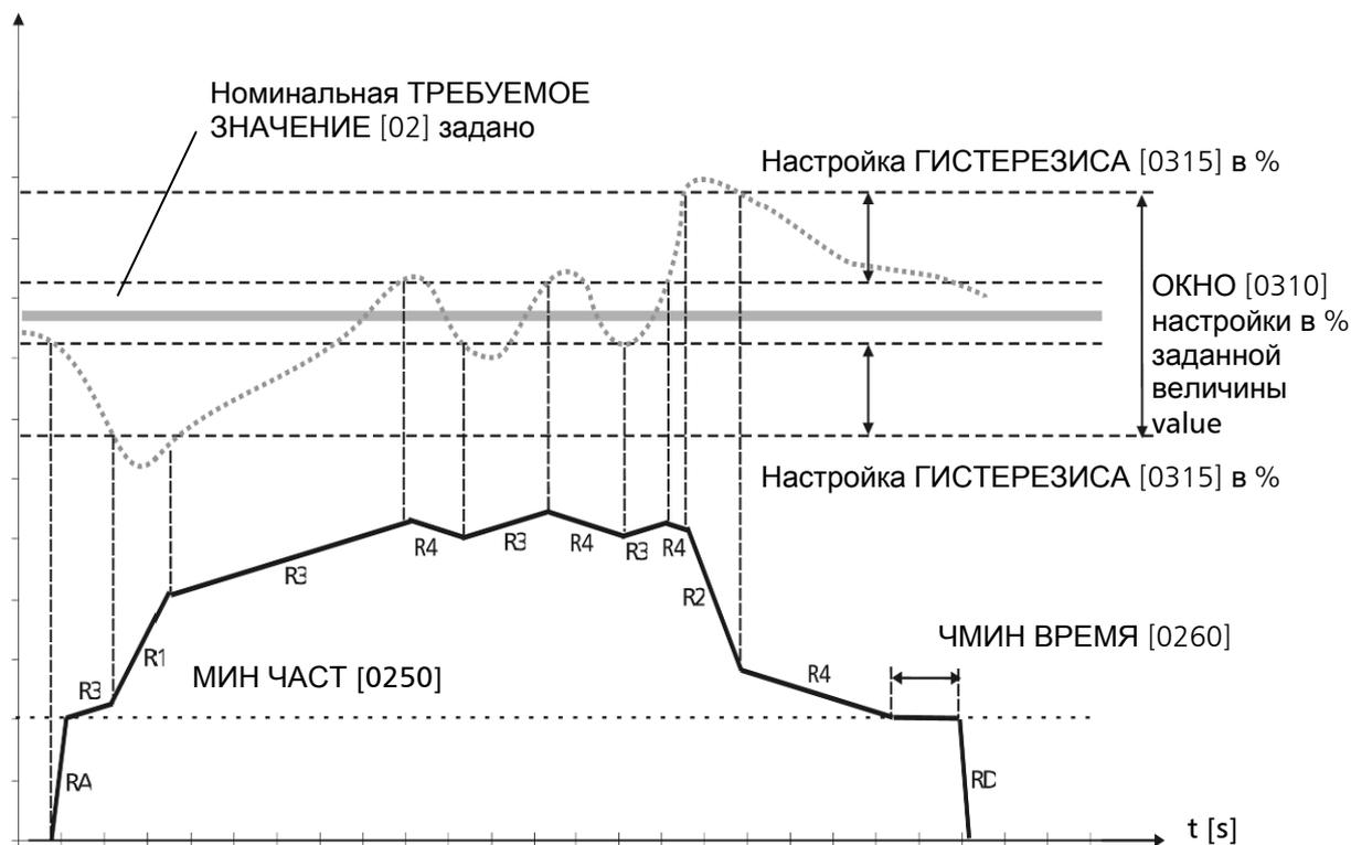
RA: Ускорение Лин изм  $F_{min}$
